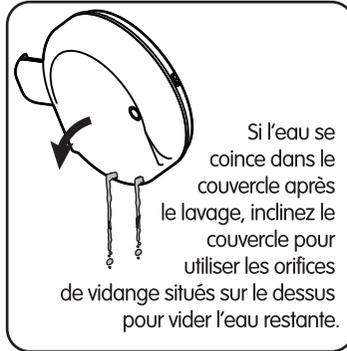
Si l'eau se coince dans le couvercle après le lavage, inclinez le couvercle pour utiliser les orifices de vidange situés sur le dessus pour vider l'eau restante.
